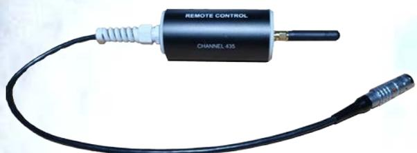
Устройство управления «Remoute Control» комплекта аппаратуры "ERA-MAX" предназначено для дистанционного управления генератором "ERA-MAX"-LHF» с клавиатуры измерителя "ERA-MAX"-IP» и вывода на индикатор измерителя установок генератора.
