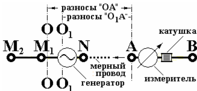
Рис.1. Схема установок ВЭЗ-А и ВЭЗ-А-1
