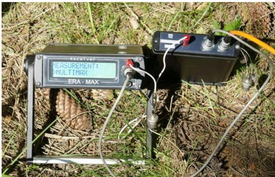
«MULTIMAX-ZOND» позволяет создавать протоколы любой степени сложности, совмещая любые типы электроразведочных установок. В зависимости от среднего сопротивления пород и минимального уровня сигнала, система самостоятельно выбирает параметры установки.
