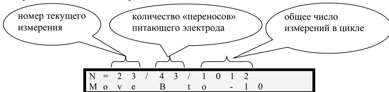
По окончании первого цикла измерений, т.е. когда будут опрошены все приемный электроды, при первом значении индекса (пикета) питающего электрода на дисплее отобразится значение «номера текущего измерения» = 0.
