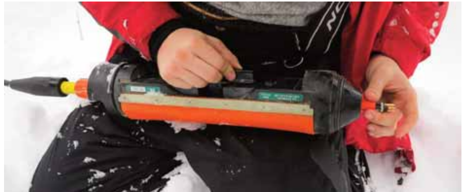
Рис. 4. Измеритель OhmMapper после поломки
