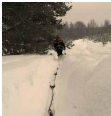
Рис. 2. Проведение измерений с помощью аппаратуры OhmMapper
